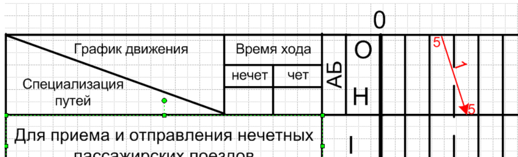
Рисунок 2.1. Пример нанесения линии хода пассажирского поезда по перегону.
