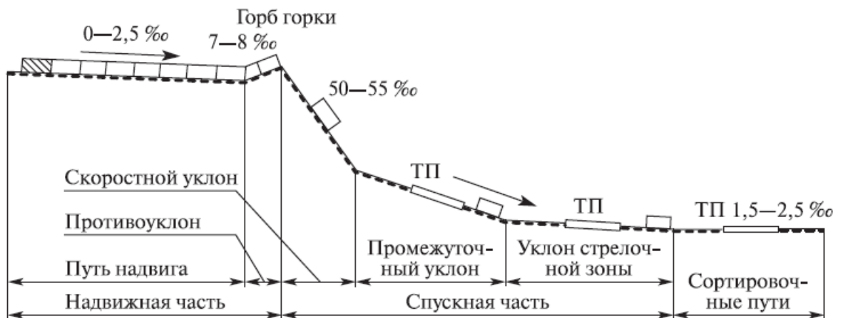
Рис.4.1 Схема продольного профиля сортировочной горки.
