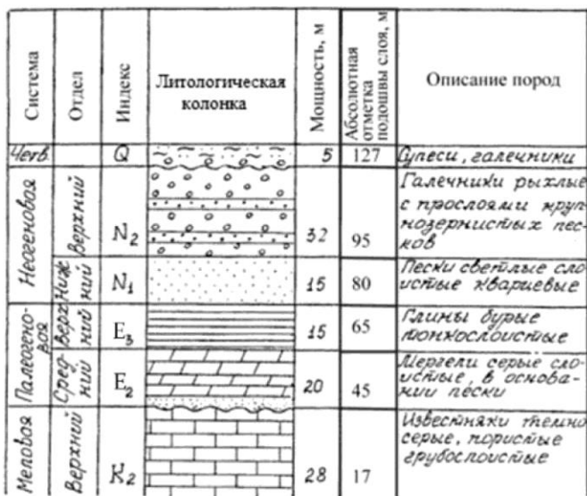
Рис. 13. Стратиграфическая колонка отложений, вскрытых скважиной с абсолютной отметкой устья 132 м.
