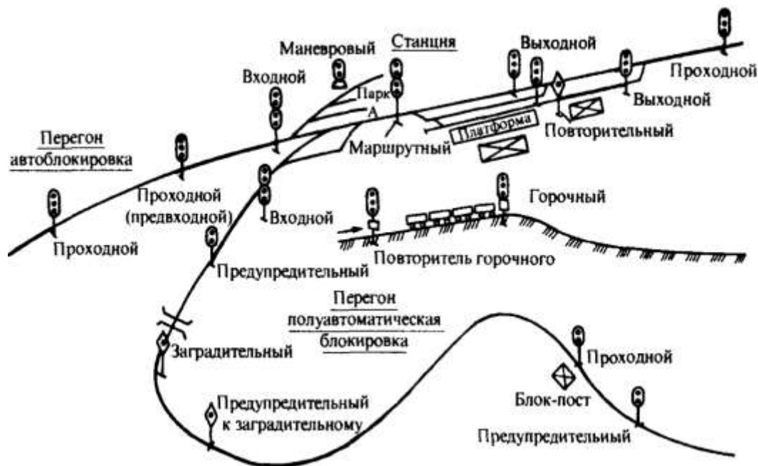
Рис. 5. Размещение светофоров различного назначения на перегонах и станции
