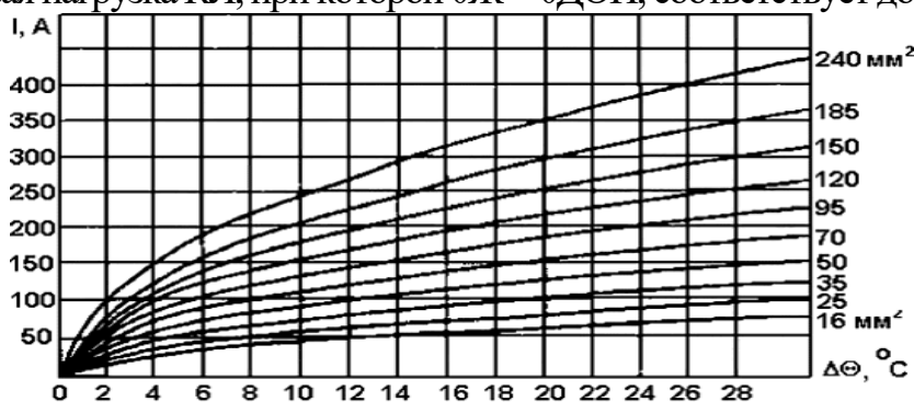
Рис. 2. Разность температур между броней и алюминиевыми жилами кабелей напряжением 10 кВ
