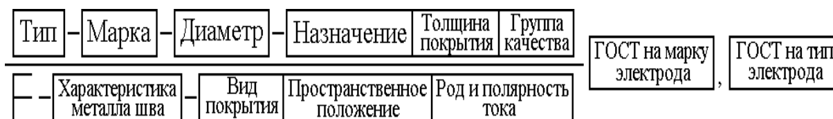
Рисунок 1.26 – Структура условного обозначения отечественных электродов
