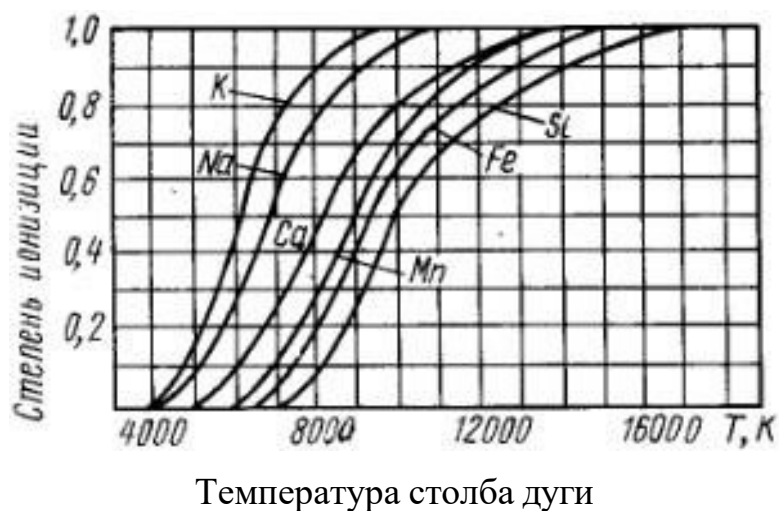
Рисунок 1.11 – График зависимости степени ионизации от температуры нагрева для некоторых веществ
